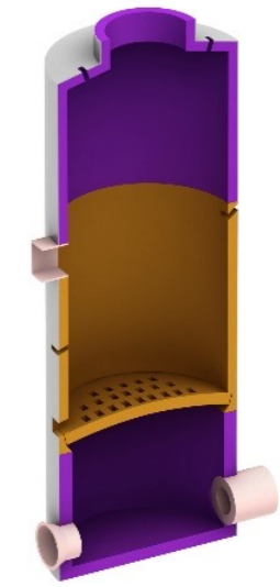
유동층 소각로 | FLUID BED INCINERATOR
