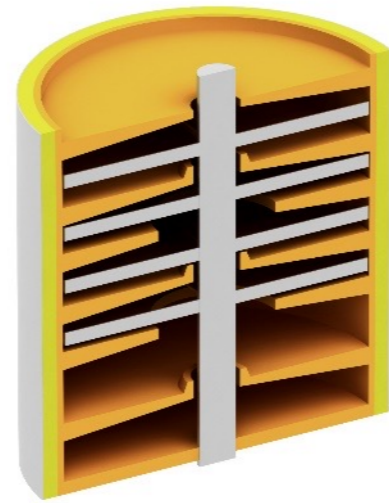
다단식소각로 | MULTIPLE HEARTH INCINERATOR
